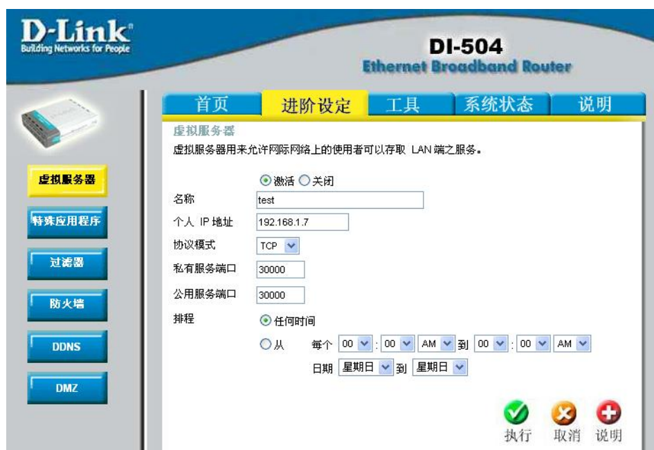
（图9）端口映射配置
