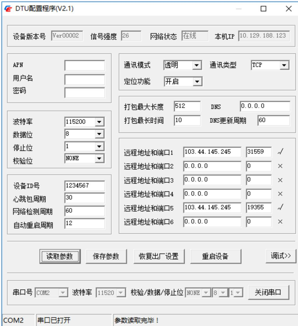
(图6) DTU配置程序读取参数
