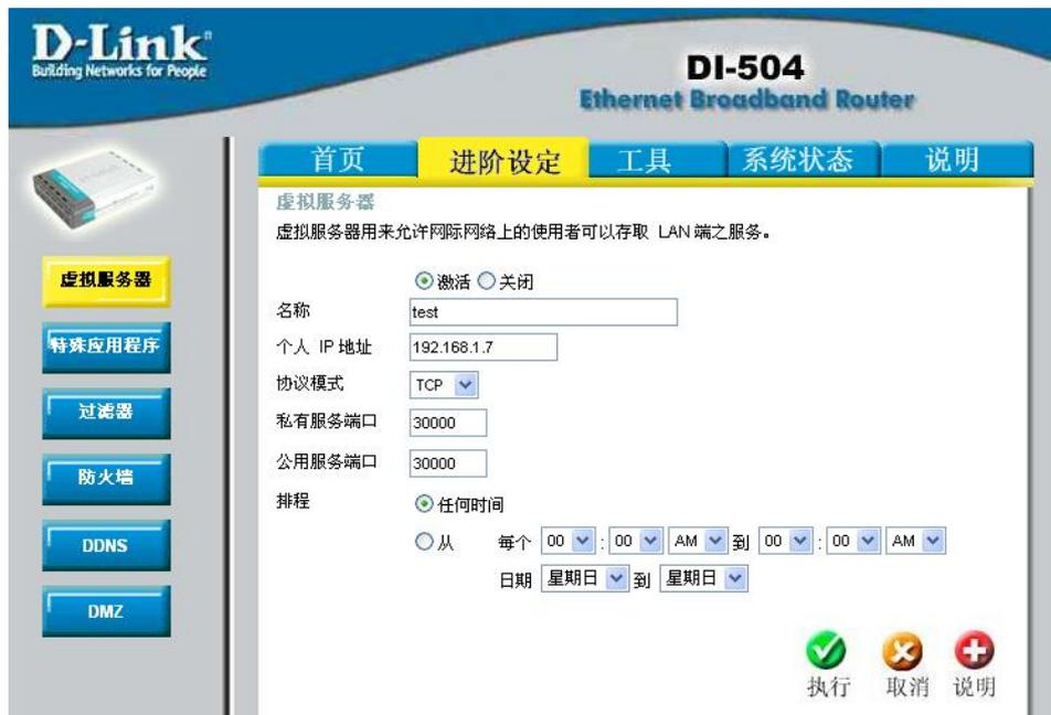
(图7) 端口映射配置
