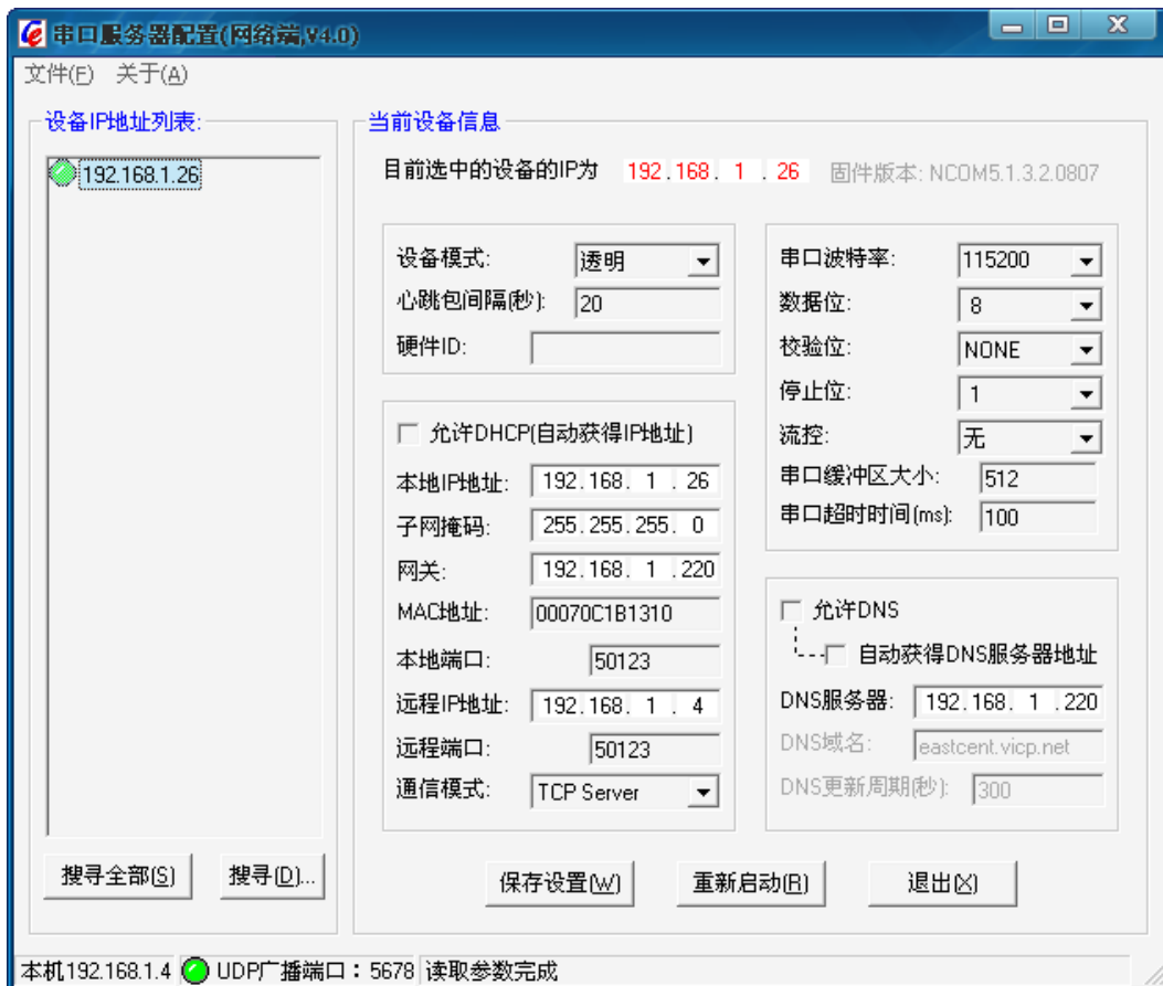
(图3) 串口服务器网络配置界面
